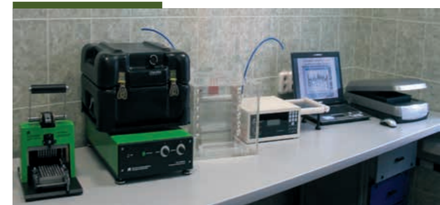
Рис. 1. Приборный комплекс (слева направо): измельчитель зерен лабораторный; устройство окрашивания гелей; система электрофоретическая; источник питания; столик с рамкой; компьютер; сканер
